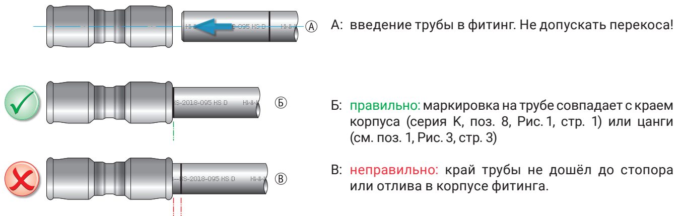
Рис. 7. Порядок монтажа труб в фитинги
